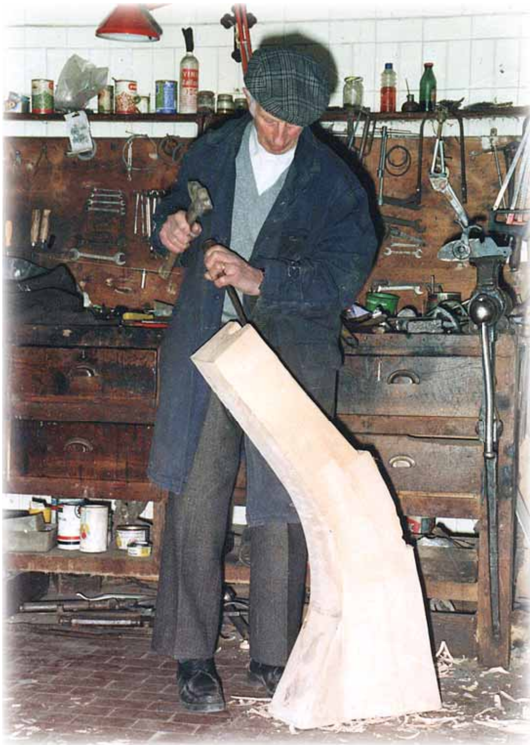
Virgilio, nella sua officina, alle prese con la sagomatura di un affusto di trombino
